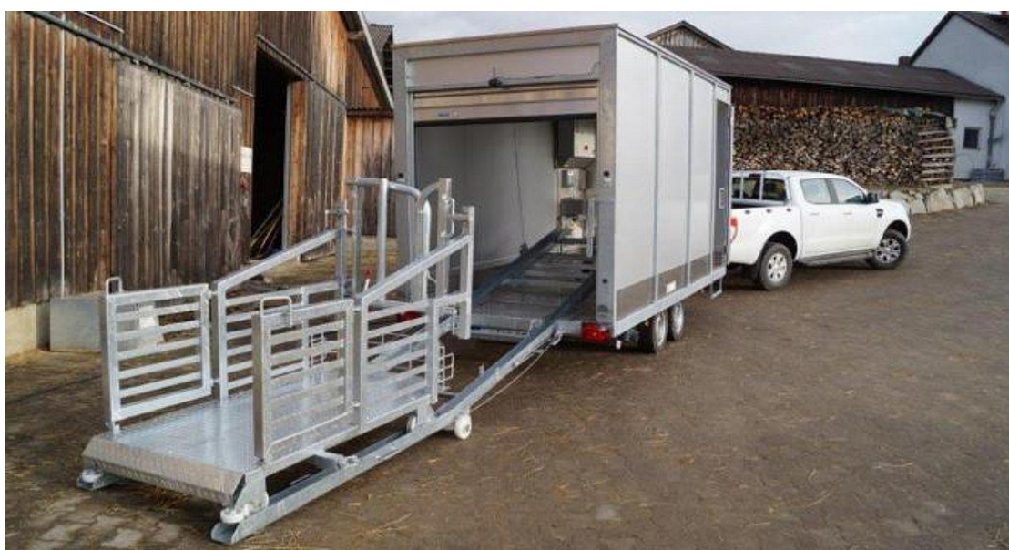
Mobilní porážková jednotka s přístupovým rampou pro skot – systém používaný v Německu
