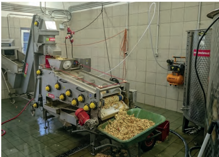
Moderní průběžné lisy velmi usnadňují práci a mají solidní výtěžnost
