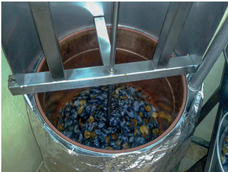
Měděný povidlový kotl s automatickým mícháním velmi usnadní práci
