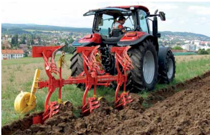
S on-land pluhem je možné jezdit mimo brázdu. Dosud nezoraná půda pojezdem tolik netrpí. Lze tak zabránit prokluzu a tvorbě utuženého podorničí. Také u on-land pluhu však platí obvyklé praktické zásady k omezení utužení půdy.
