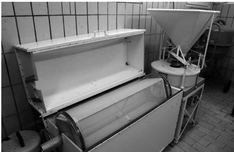
Obilný mlýn se sítý. Pluchy a klíčky jsou sítý odstraněny. Výsledkem je velmi pěkná a jemná mouka.
